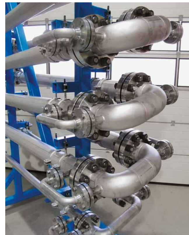
Réacteur PFR avec 1000 kg h -1 et temps de séjour de 20 min
