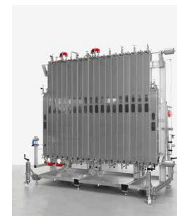
ContiplantPILOT pour les applications basse température, avec isolation spéciale haute performance
