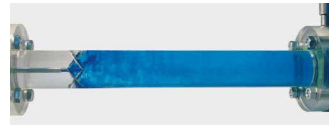
5% d'additif bleu injecté en amont d'un Aquamix (Re = 18000)
