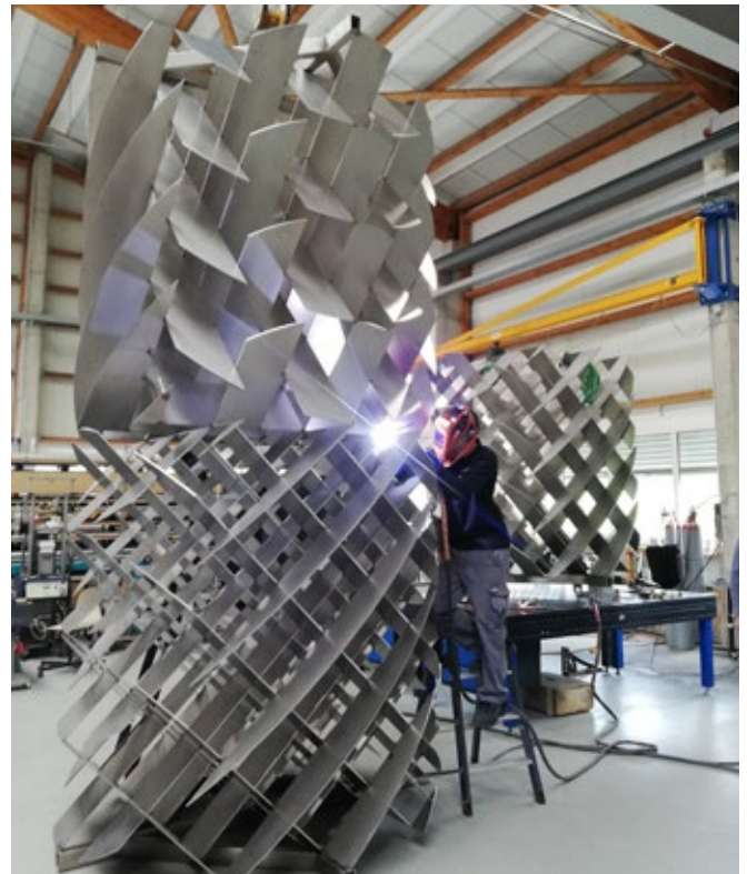
Herstellung einer Verweilzeitstrecke im Produktionsmassstab
