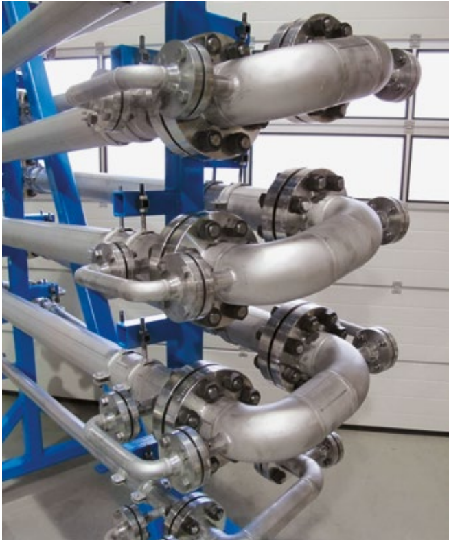
PFR-Reaktor mit 1000 kg h -1 und Verweilzeit 20 min
