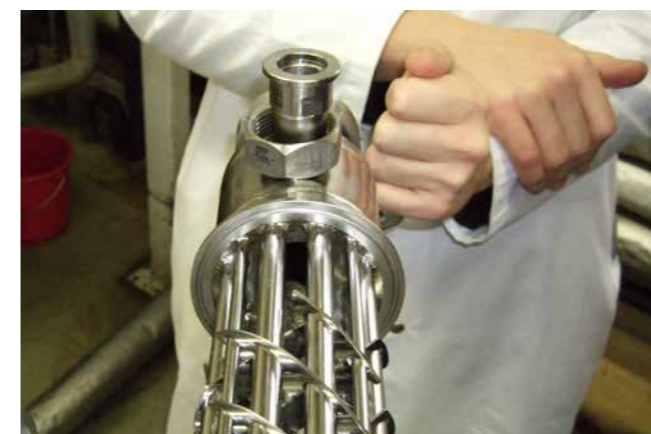
Inspection par le client après nettoyage NEP
