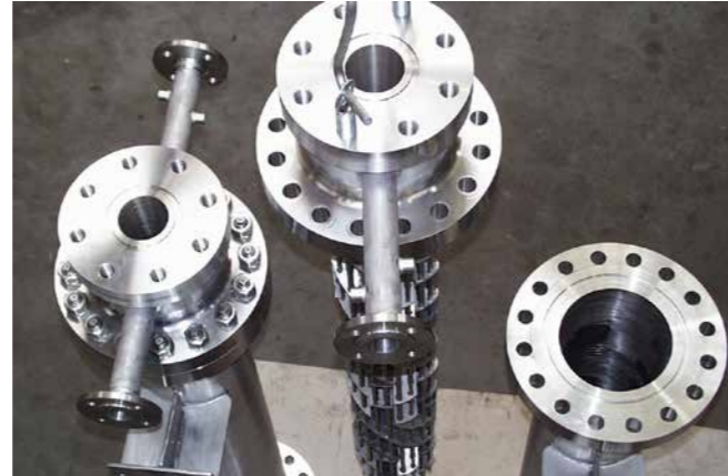
Réacteur de polymérisation DN250
