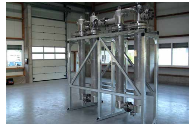
Section de réaction à temps de séjour composée de 6 mélangeurs/échangeurs de chaleur en ligne Fluitec.
