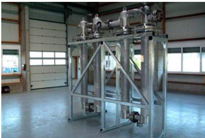
Verweilzeitreaktionsstrecke aus 6 Fluitec Mischer-Wärmetauscher in Serie
